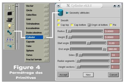
Surfacique donc, **EQUINOX-3D** travaille à partir d'une esquisse 2D qu'il va déplacer soit par révolution (*Revolve*) autour d'un axe du repère OXYZ, soit par extrusion (*Extrude*) suivant une normale au plan de l'esquisse, soit par translation (*Extrude along spline*) le long d'un chemin, soit, enfin, par tension d'une peau sur des armatures (*Skin from cross-section*).
